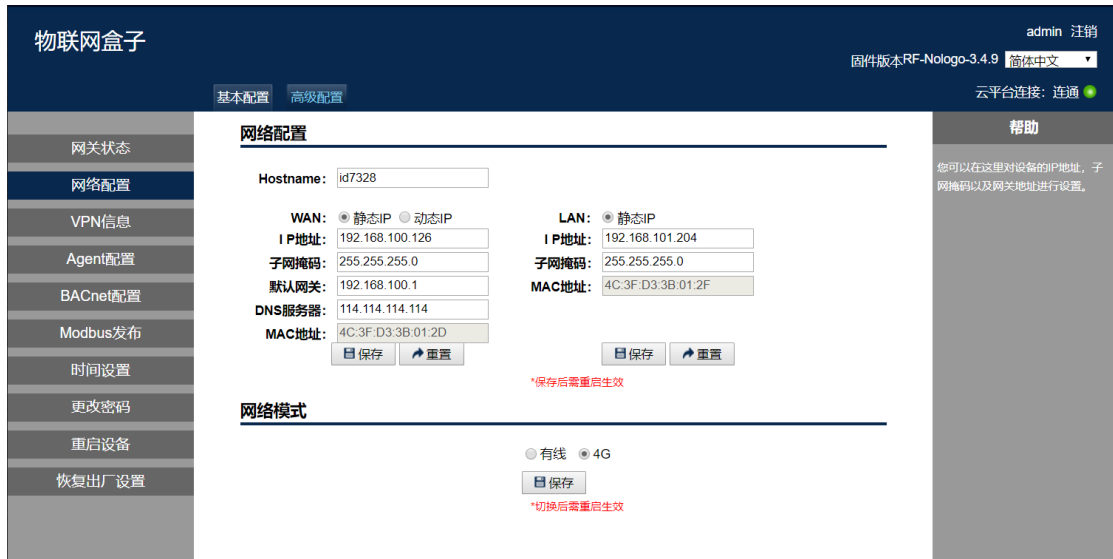
图 1-38 远程修改网关IP地址
